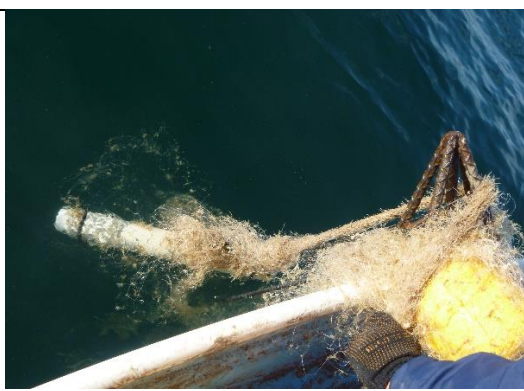
CPOD 声学探测器用于定位小头鼠海豚。而这个被取回的探测器则被刺网缠绕其中 图片来源：Paco Valverde
